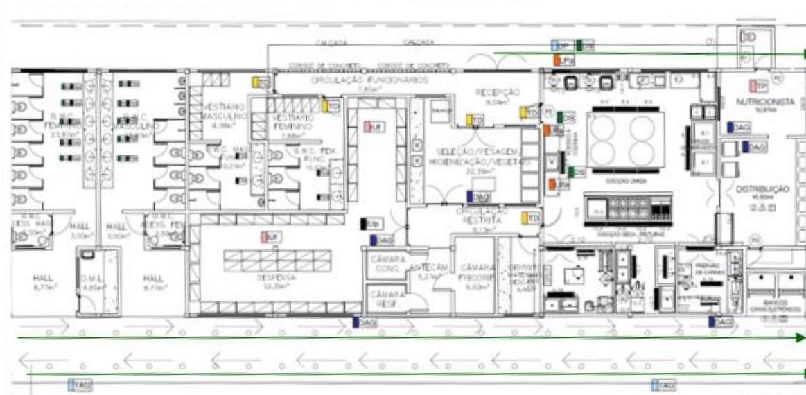
Figura 3G. Planta baixa, Bloco do Restaurante Universitário - Estrutura de Armazenamento e Produção de Alimentos, Vestiários de Funcionários, Campus UFPI - Profa. Cinobelina Elvas, Bom Jesus-PI, com rota de fuga ao ponto de encontro. Fonte: UFPI.
