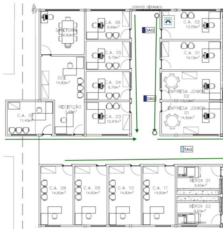
Figura 38. Planta Baixa, Bloco do Restaurante Universitário - Setor de Centros Acadêmicos, Empresas Júnior, Diretório Acadêmico, com rota de fuga ao ponto de encontro. Fonte: UFPI.
