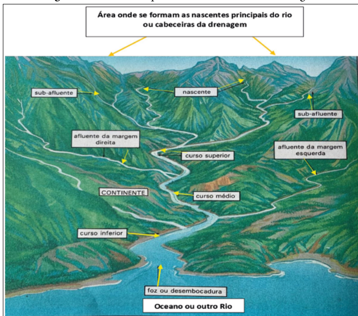
Figura 8 - Desenho esquemático de uma rede de drenagem
