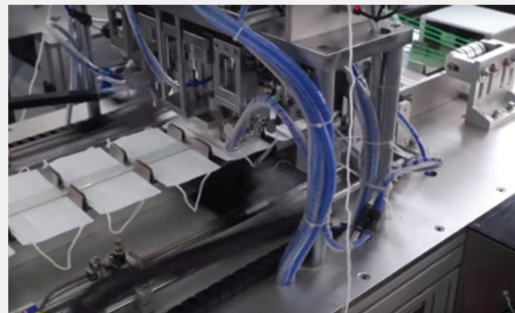
Figura 8: Colocação de atilhos nas máscaras (Adaptado de Dongguan KYD Automatic Mask Machine Factory Co., Ltd)
