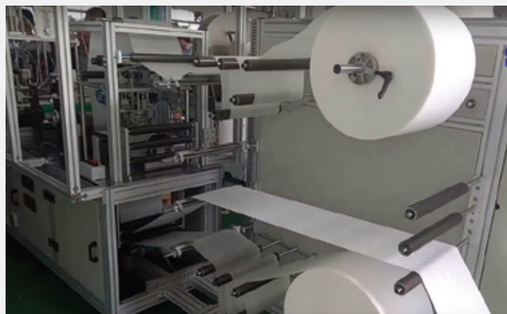
Figura 5: Produção de máscaras auto-filtrantes achatadas (adaptado de Dongguan KYD Automatic Mask
