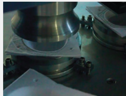
Figura 12. Colagem e corte das camadas constituintes das máscaras (Adaptado de HT Tech Machinery)
