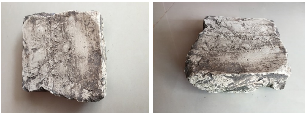
Figura 59 Tijolo cozido feito com a mesma argila de assentamento das alvenarias
