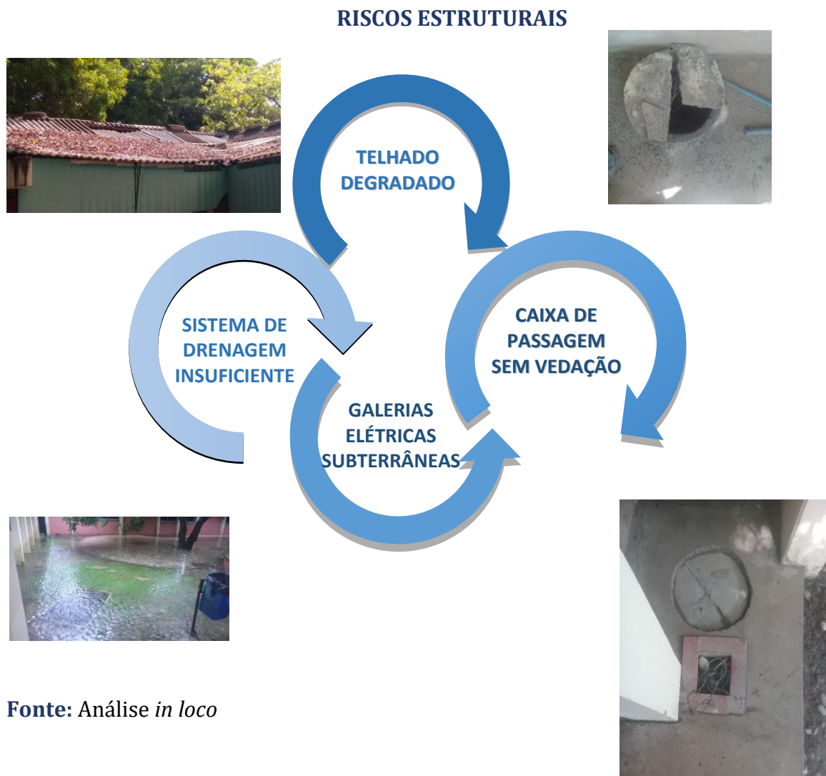
Figura 5 – Configuração dos riscos estruturais do CCHL
