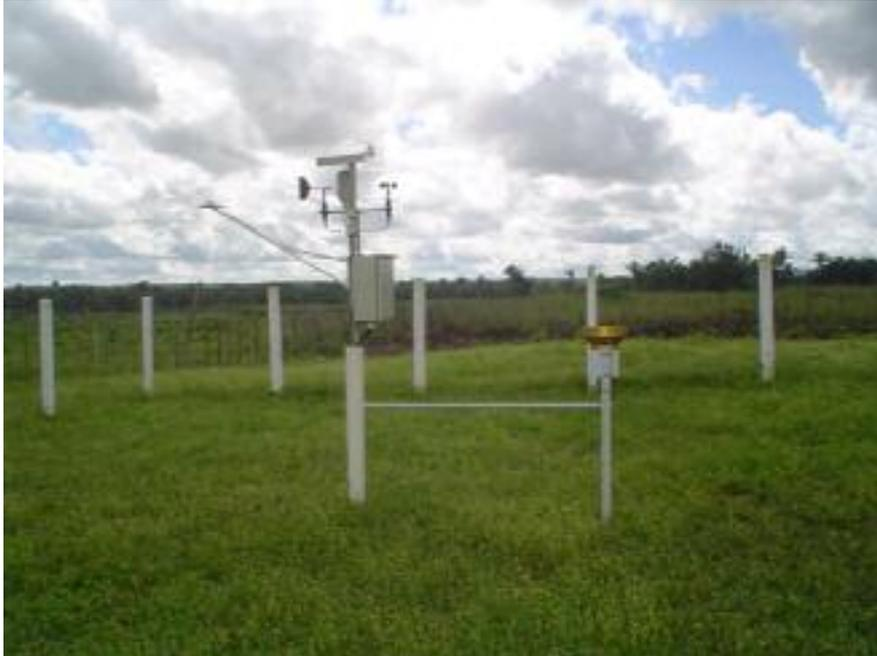
**Figura 5.** Estação agrometeorológica automática da Embrapa Meio-Norte. Teresina, PI.
