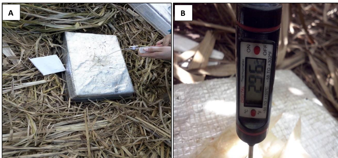
Figura 3. Modelo de câmara utilizada para coleta de amostras de gases (A) e termômetro utilizado para medição da temperatura no interior da câmara (B).
