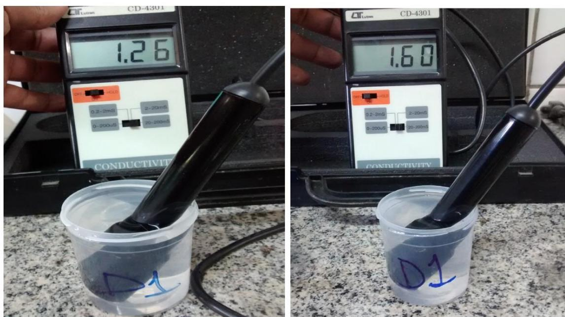
**Figura 3.** Leitura da condutividade elétrica em condutímetro, modelo Lutron CD-4301. Teresina, PI, 2016.
