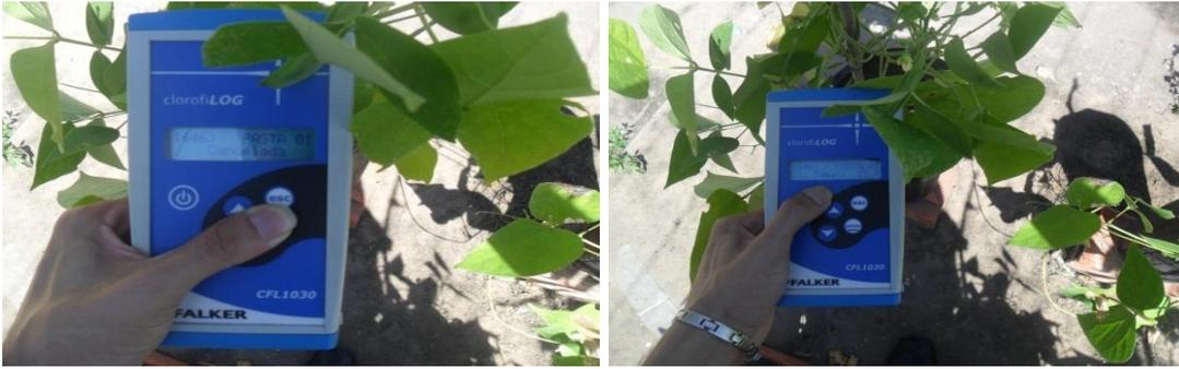
**Figura 4:** Detalhes da determinação do teor de clorofila
